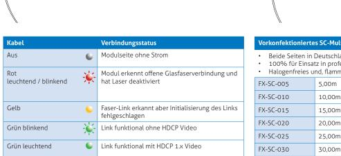
Modul erkennt offene Glasfaserverbindung und hat die Laser deaktiviert. USB ist angeschlossen
